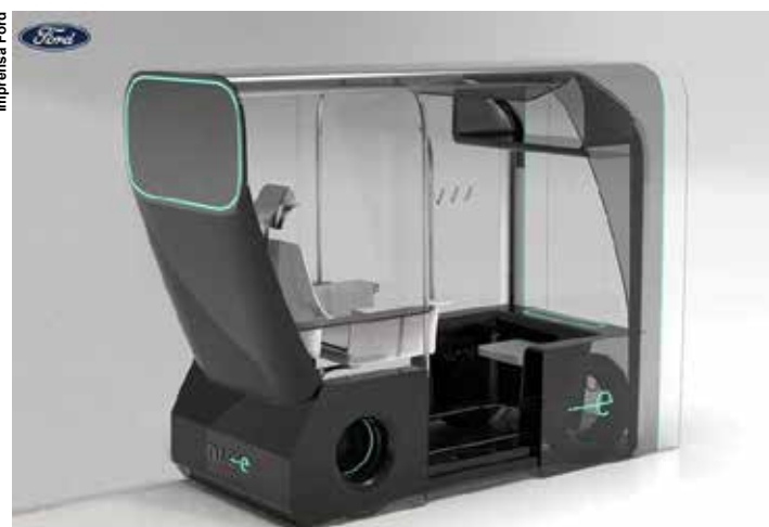
O conceito “muvone”, criado por estudantes britânicos, transporta só uma pessoa e tem superfícies planas, fáceis de limpar.
